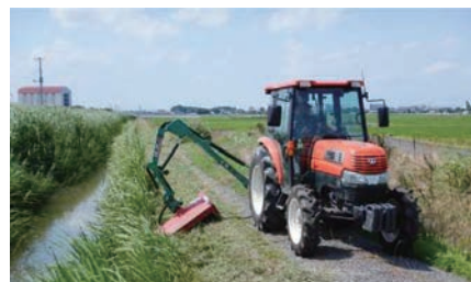
【写真①】改良区所有のハンマーモアを使用。安全かつ効率的な草刈りができる。
